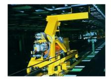
Fig. 4: Extrusion puller
