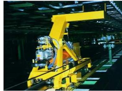
Fig. 4: Extrusion puller
